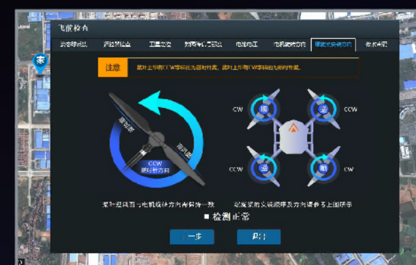
直观检测飞机安装调试状态是否正确
