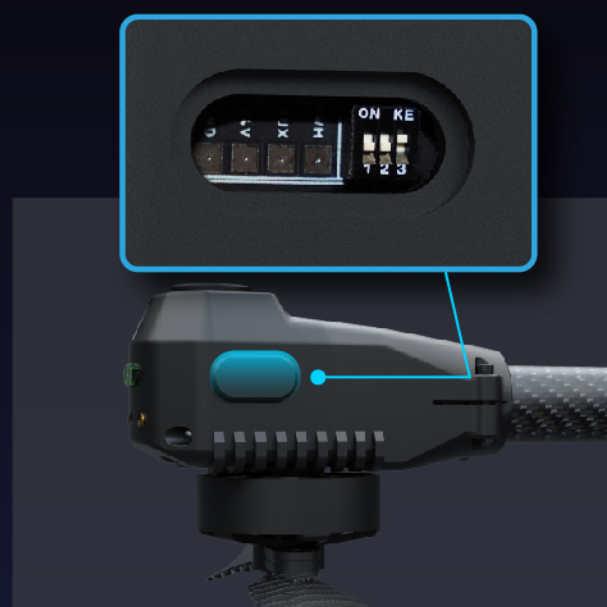
四组电机座一侧的检测口 主要检测执行机构信号及电源
