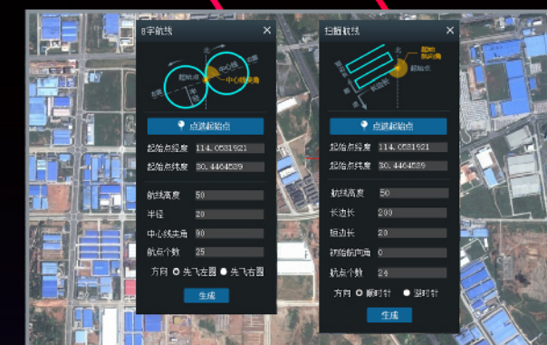
多种标准模板航线，可快速绘制复杂图形
